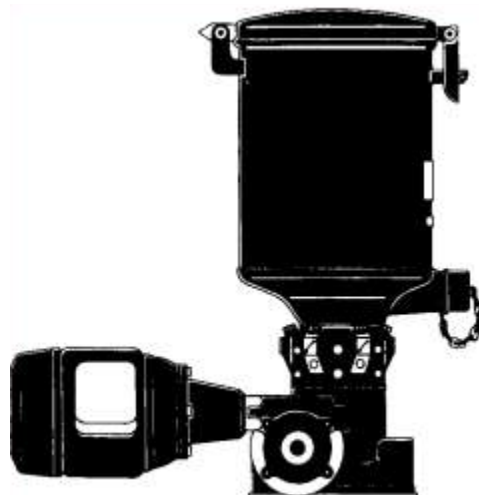
Obr. 4 Mazací přístroj s pohonem elektromotorem (pro olej i plastické mazivo, cca 48 vývodů, max. tlak 200 bar, až 300 cm 3 /hod na vývod).
