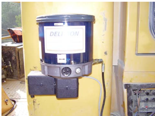
Obr. 10 Detail 24V DC mazacího přístroje.
