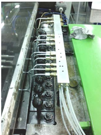
Obr. 2 Trysky a dávkovače technologického dávkovacího jednopotrubního centrálního mazacího systému pro tváření za studena.
