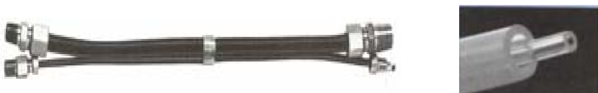
Obr. 5 Pohled na potrubní vedení, vpravo koaxiální potrubí pro vedení vzduchu a maziva.
